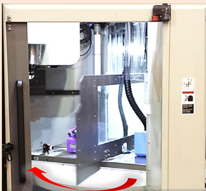
obr. 4, VÝMĚNA DVOU STOLŮ NA 2- PALETOVÉM STROJI HYUNDAI WIA F 600 D
