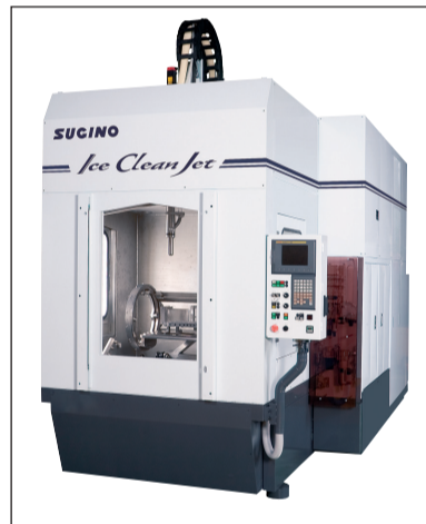
Sugino Jet Clean používá kinematiku CNC obráběcího centra a spolu s technologií řízeného vodního paprsku je primárně určeno k vysokotlakému odjehlování a začištění hran obrobků, spolu s mytím a dokonalým zbavením třísek a jemných šponek v obrobcích
